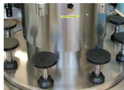
Assenza contatto tra valvola di riempimento e imboccatura
