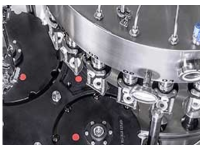
Trasferimento bottiglie con stelle in continuo
